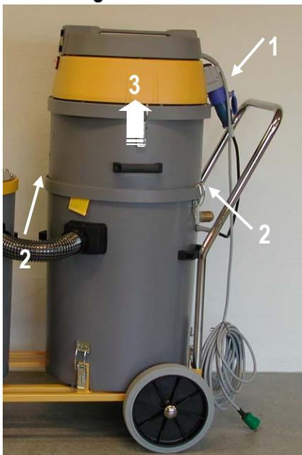
Der Filtersack im Behälter 2 hält Schlamm und kleine Partikel zurück. Er wird nach Bedarf entleert.
