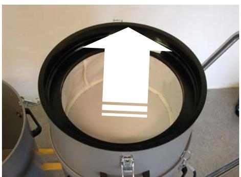
Die Luft wird endlich vom Mikro-Vorfilter filtriert, welches Filter eventuelle kleine Partikel im Luftstrom zurückhält. Hierdurch sichert man sich, dass die Ausblauluft von Staub gereinigt ist, gleichzeitig damit dass die Saugmotoren geschont werden.
