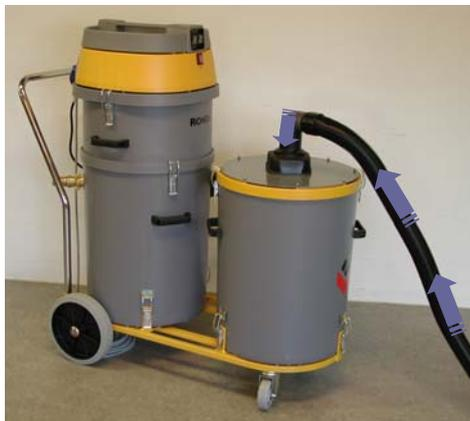
Wenn der Saugmotor der Maschine eingeschaltet ist, wird die Luft durch die Maschine gezogen und sammelt die Flüssigkeit in der Nähe der Bodendüse.
