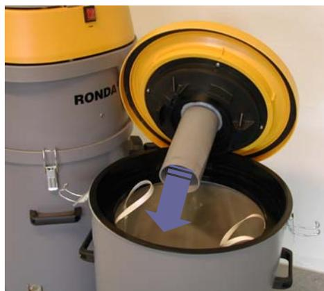
Die Flüssigkeit wird durch das Leitrohr zum Aufnahmekorb geleitet, der alle großen Partikel, Späne usw. zurückhält.
