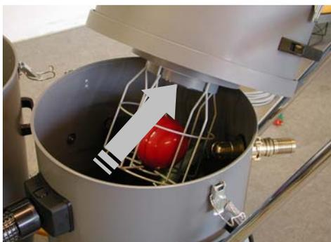
Der Luftstrom läuft vorbei das Schwimmventil weiter und in den Flüssigkeits-/StaubVorabscheider hinauf.
