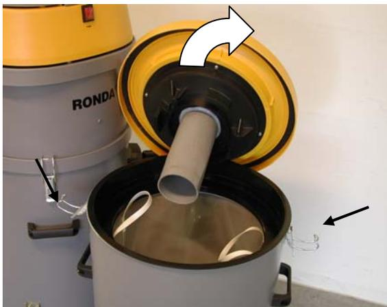
Der Aufnahmekorb im Behälter 1 hält die großen Partikel zurück und wird nach Bedarf entleert. Wenn der Aufnahmekorb fast gefüllt ist, wird das Aufsaugen eingestellt. Die Maschine bei eventuellen Flüssigkeiten den Behälter 1 leeren lassen, bevor die Maschine ausgeschaltet wird.
