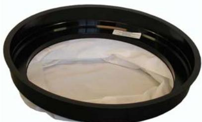
Das Mikro-Vorfilter wird unter dem Motorkopf vom Filtergitter festgehalten. Das Mikro-Vorfilter hält die feinen und kleinsten Staubpartikel zurück, und schützt gleichzeitig die Turbinenblätter der beiden Saugmotoren. Die Turbinenblätter können beschädigt werden, wenn es verschleißende Partikel im Luftstrom gibt.
