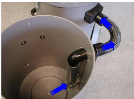
Das Saugrohr, das dicht an den Boden des Sammelbehälters 1 einmündet, zieht die filtrierte Flüssigkeit vom Behälter 1 durch den Verbindungsschlauch zum Behälter 2.
