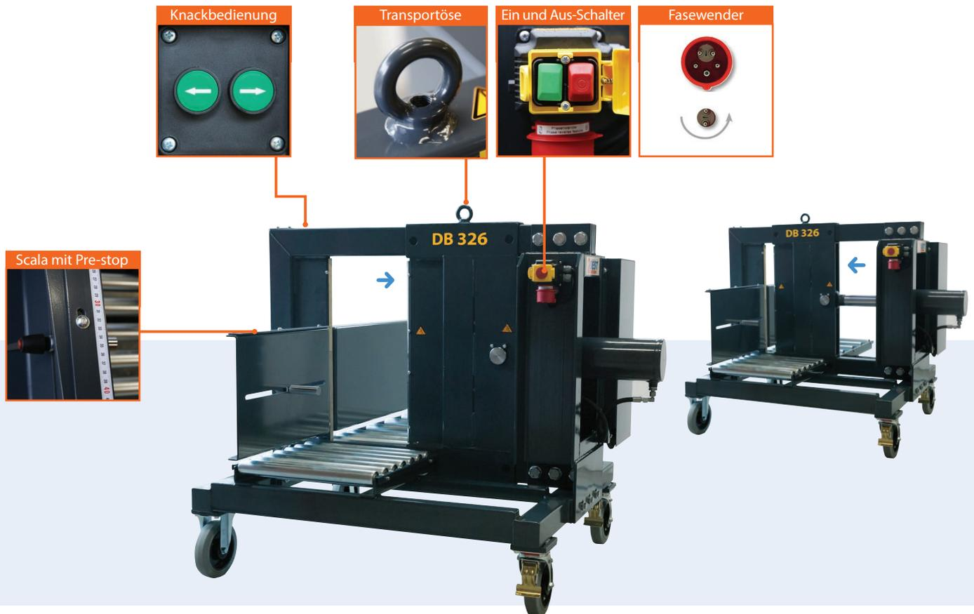
Der DUST-BEST 326 knackt vertikal. Dies hat den entscheidenden Vorteil, dass die Elemente mit dem Kran auf die Rollbahn gestellt werden können. Von dort können sie direkt geknackt werden ohne vorher umständlich auf die Seite gelegt zu werden. Ein schnelles und wirtschaftliches Arbeiten wird dadurch ermöglicht.
